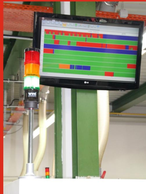
Le logiciel affiche les statuts des colonnes lumineuses intégrées au réseau. L'utilisateur peut en outre analyser la productivité, rechercher les sources d'erreur et ainsi augmenter l'efficacité et la disponibilité de ses machines.
