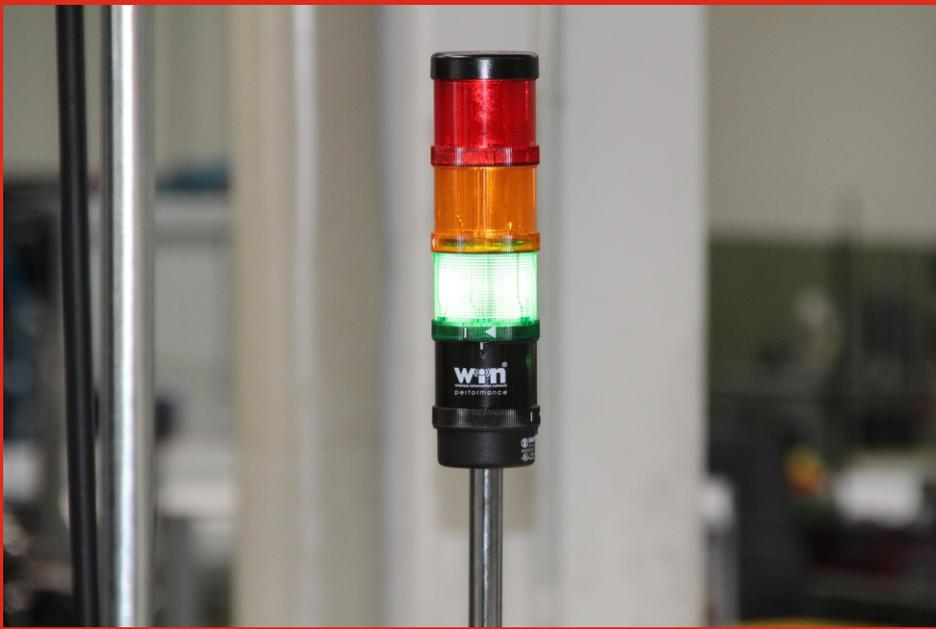
Chez Ketterer, chaque machine est équipée d'une colonne lumineuse WERMA comprenant le module SmartMONITOR. Celui-ci est tout simplement intégré par Plug & Play comme élément supplémentaire dans les colonnes lumineuses de WERMA déjà installées, et permet de surveiller les statuts ou les nombres de pièces produites par les machines et installations.
