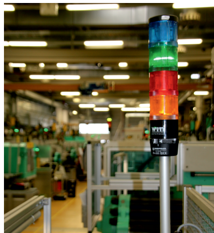
MDE-Signalsäule in der Spritzgießabteilung in den Fertigungsräumen der Marquardt GmbH.
