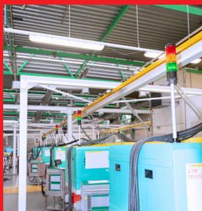
Chaque machine comportait déjà une colonne lumineuse WERMA qui a pu être rapidement et facilement complétée par un module SmartMONITOR.
