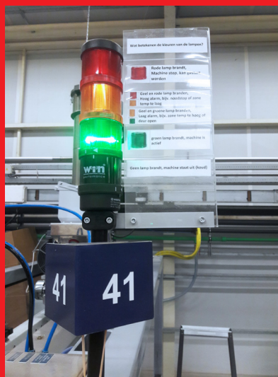
Todos los estados se transmiten por radio al receptor de radio, que transmite todos los datos de forma íntegra y los guarda en una base de datos SQL de Microsoft.
