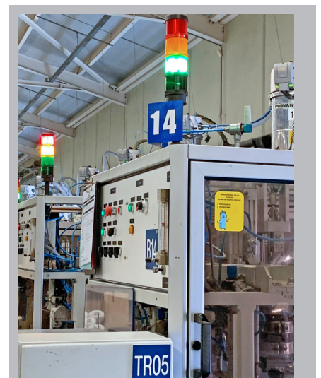
Peu importe le type, l'âge ou le fabricant des machines, le système MDC de WERMA repose uniquement sur une colonne lumineuse WERMA jouant le rôle d'interface.
