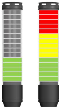
In diesem Modus haben die Stufen feste Positionen und können aus sein, wenn die entsprechende Stufe und das optische Signal nicht aktiviert wird.
