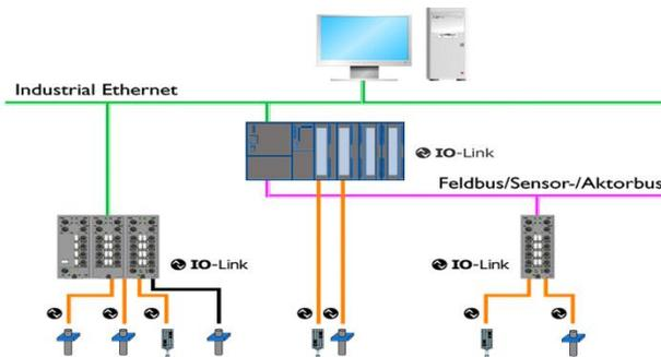
Es wird die bekannte Verbindungstechnik mit ungeschirmten M12-Kabeln verwendet. Dabei wird die 3-Leiter-Verbindung eines digitalen Schaltsignals um die bidirektionale Kommunikation erweitert.
