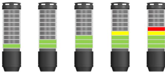
Die eSIGN-Segmente werden als Füllstandsanzeige verwendet. Die Bandbreite reicht von 0%, wenn alle Segmente ausgeschaltet sind, bis zu 100%, wenn alle Segmente aktiviert sind. Dies ermöglicht eine präzise Signalisierung des Auftragsfortschritts oder der Materialverfügbarkeit in Maschinenprozessen in Form eines aufbauenden oder abfallenden Leuchtbilds.
